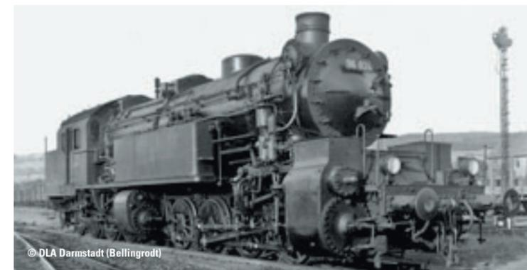
**Vorbild:** Schwere Güterzuglokomotive Baureihe 96.0 der Deutschen Reichsbahn-Gesellschaft (DRG). Gelenklokomotive Bauart Mallet mit Verbundtriebwerk aus Hoch- und Niederdruck-Zylindergruppen. Betriebsnummer 96 024. Betriebszustand um 1930/31.
